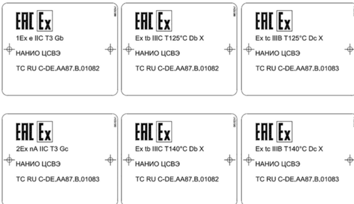
Эксплуатация двигателей разрешается только в таких условиях, для которых является допустимым класс взрывозащиты, указанный на его типовой табличке. Обязательными для соблюдения являются также указанные на типовой табличке температурные классы и максимальная допустимая температура поверхности.
