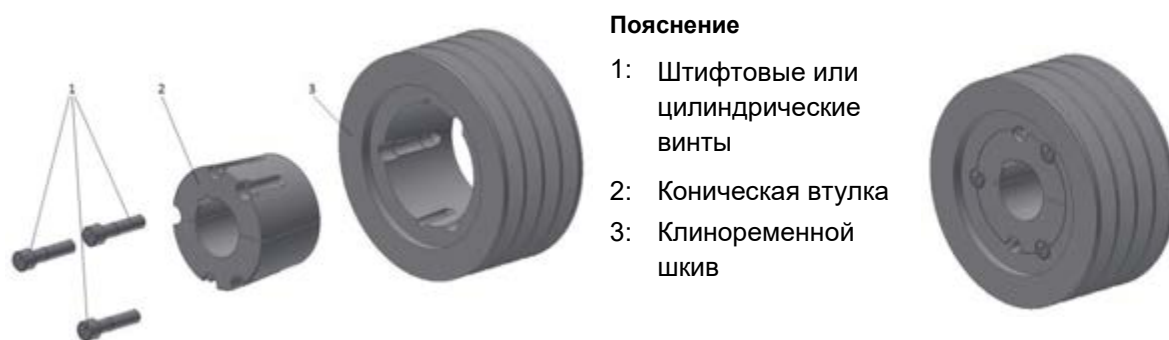
Рис. 14: Клиновидный шкив (в разобранном и собранном состоянии)
