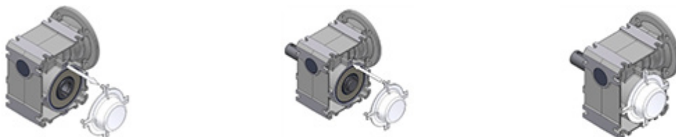
Рис. 16: Монтаж и демонтаж колпака
